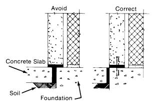
EXPANSION JOINT OVER CONCRETE SLAB FIG. 22
