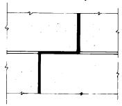
VERTICAL EXPANSION JOINT WITH HORIZONTAL OFFSET
